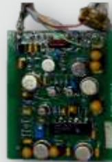
منظم جهد تثبيت الصورة لوحة دائرة الطاقة
